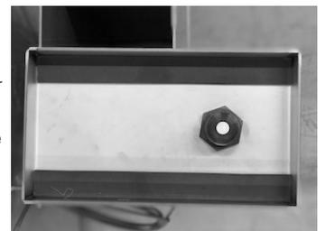
3. Éliminer la poussière et les débris du fond du boîtier de détection.
