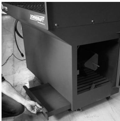
6. Insérer le filtre de rechange propre.
