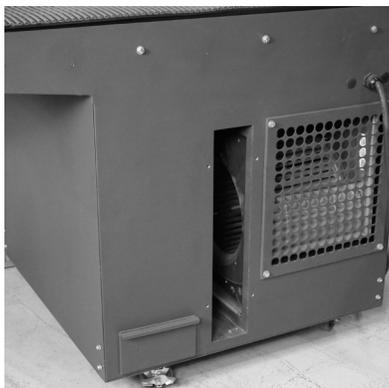
5. Insérer le filtre de recharge propre.
